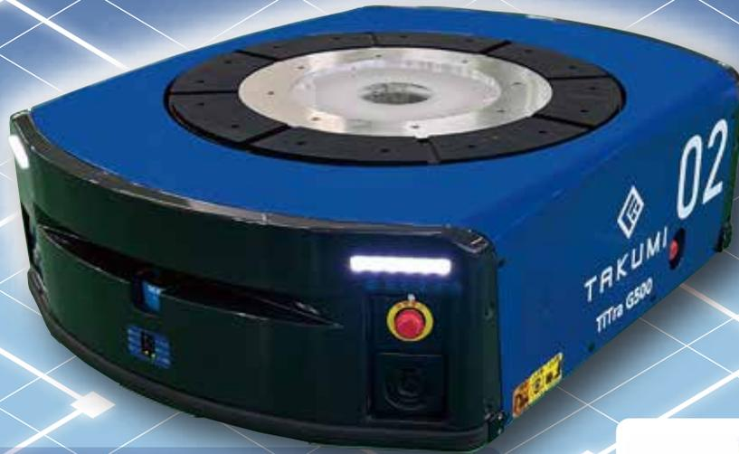
床面に基盤目状に敷設したマトリクスコードを読み取りながら搬送するタイプです。従来、人が棚まで歩いてピッキング作業をしていた工程をロボットが棚を持ってこることで人の移動時間を大幅に削減することが出来ます。また、製造工場での工程間搬送に能力を発揮します。
